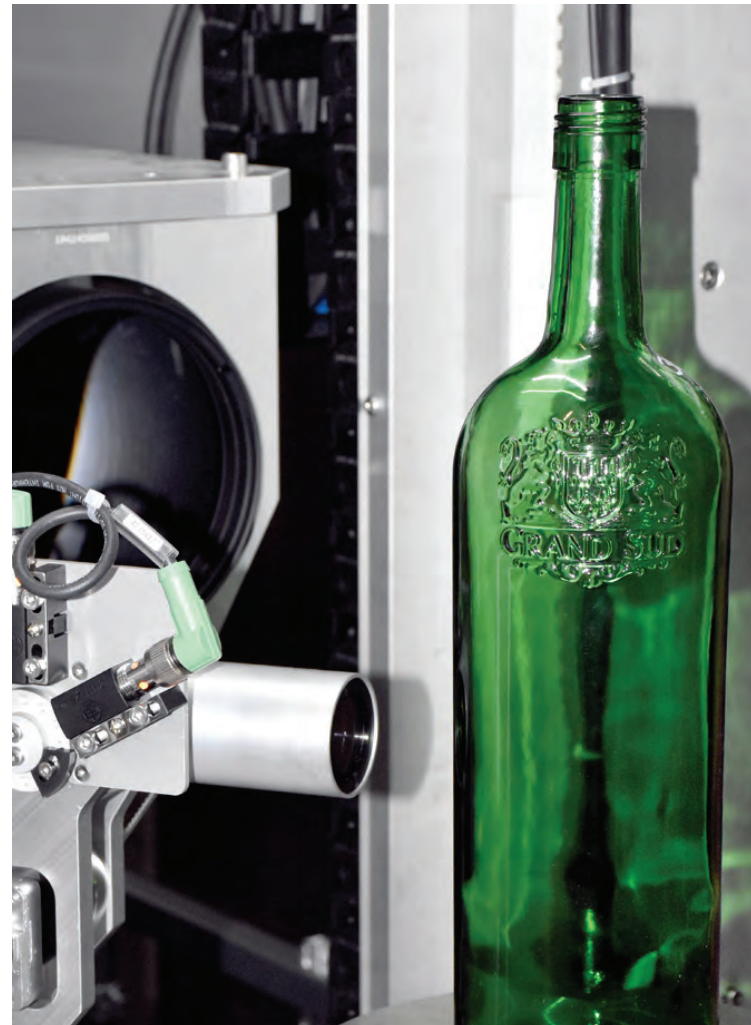
estación de medición de espesor de pared
